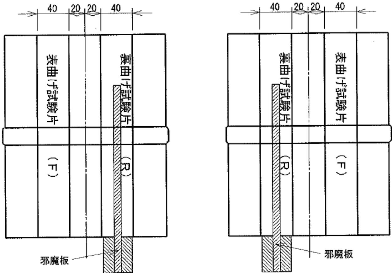
中板競技材は、邪魔板の位置から裏曲げ試験片を採取し、邪魔板のない位置から表曲げ試験片を採取する。
